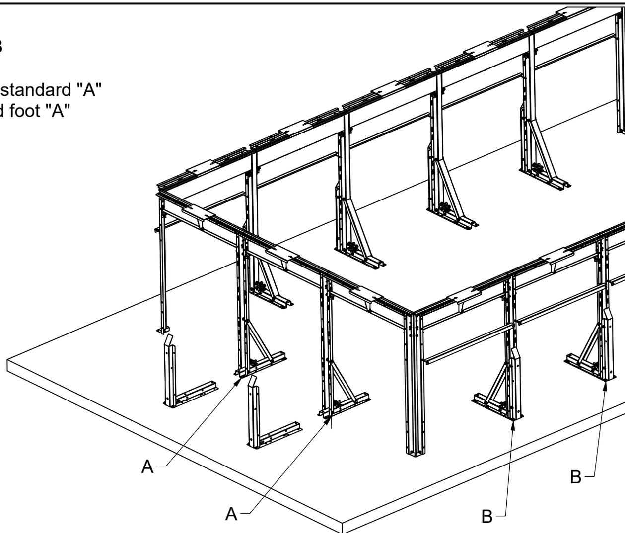
Nota : i tralicci della testa della vasca del lato dove verrà realizzato il locale tecnico vanno assemblati con il profilo inferiore inox come nelle altre versioni Dolcevita (traliccio standard "A"). Il resto dei tralicci vanno assemblati con l'apposito profilo inferiore saldato necessario per ospitare le lamiere contenimento terra (traliccio Divina "B")
