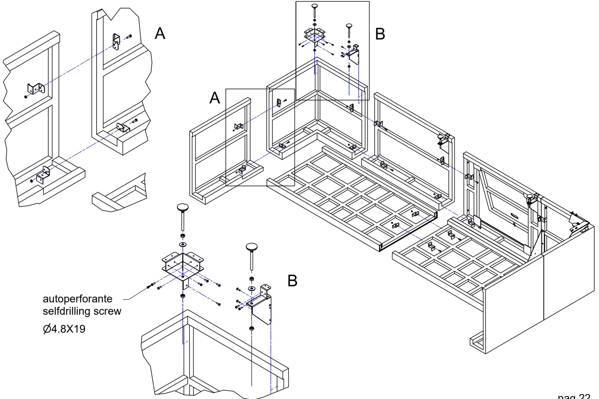
ASSEMBLAGGIO PANNELLI TESTATA GAVONE
