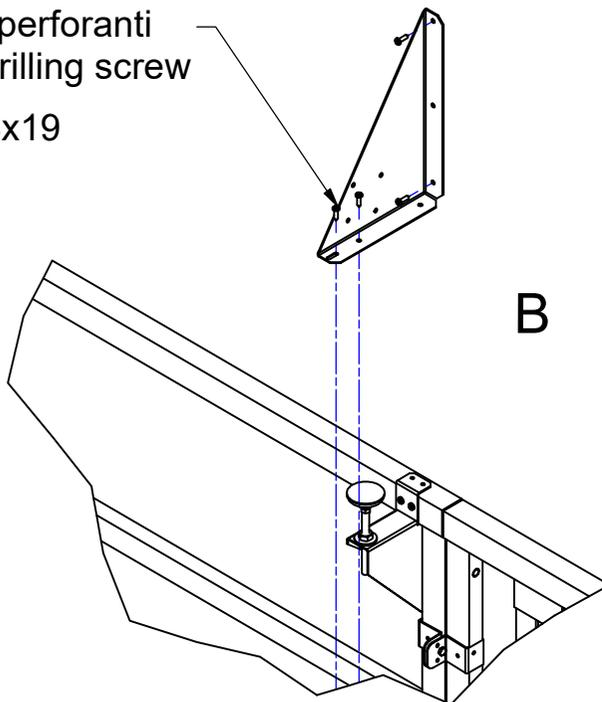
ASSEMBLAGGIO PANNELLI TESTATA GAVONE
