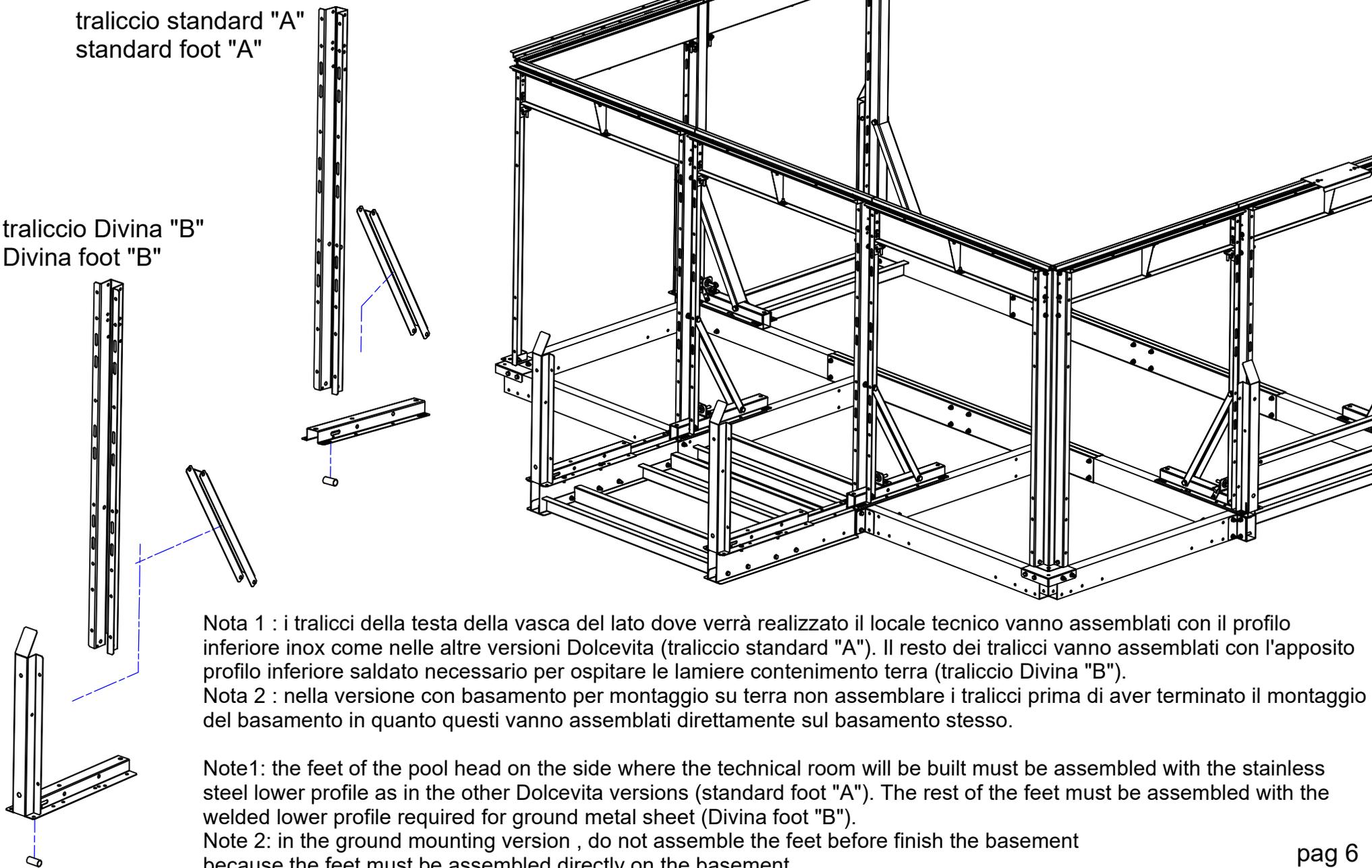
Nota 1 : i tralci della testa della vasca del lato dove verrà realizzato il locale tecnico vanno assemblati con il profilo inferiore inox come nelle altre versioni Dolcevita (traliccio standard "A"). Il resto dei tralci vanno assemblati con l'apposito profilo inferiore saldato necessario per ospitare le lamiere contenimento terra (traliccio Divina "B").
