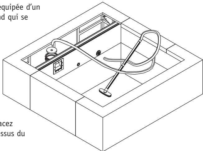
Une fois le tuyau rempli d'eau, insérez l'extrémité dans le trou située sur l'assiette de skimmer en prenant soin de le sortir le moins possible de l'eau. Une fois que l'aspirateur manuel de fond est en route, il doit être utilisé comme
