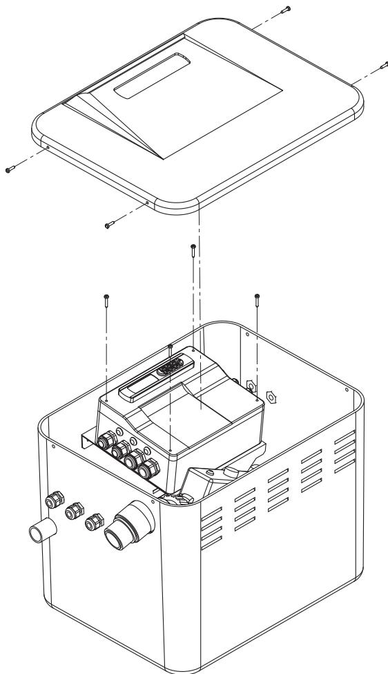
**Der elektrische Anschluss muss mit einem FI-Schutzschalter abgesichert sein. Der Masse-anschluss muss angeschlossen sein.**
