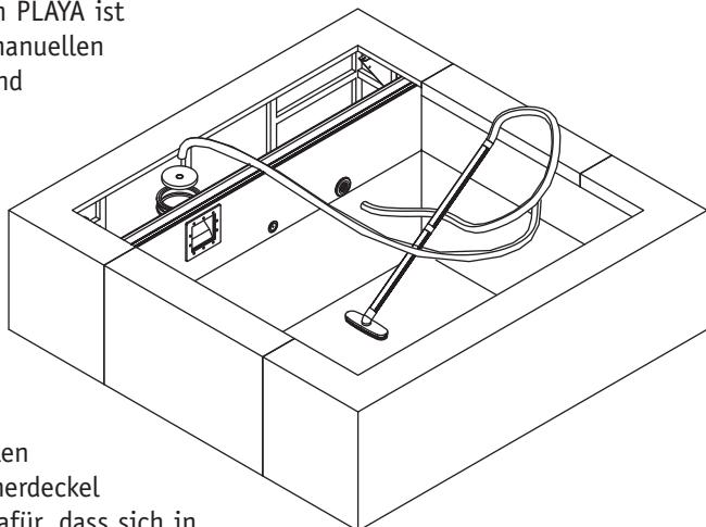
Stecken Sie den Bürstenkopf, die beiden festen Rohre, den flexiblen Schlauch und den Skimmerdeckel zusammen. Sorgen Sie dafür, dass sich in den Rohren und dem Schlauch keine Luft befindet und decken Sie den Skimmerdeckel auf den Skimmer.
