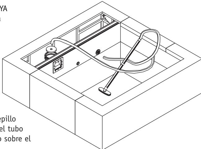
Ensamblar el limpia-fondos conectando el cepillo con los tubos rígidos y el tubo flexible. Colocar el disco sobre el prefiltro del skimmer.
